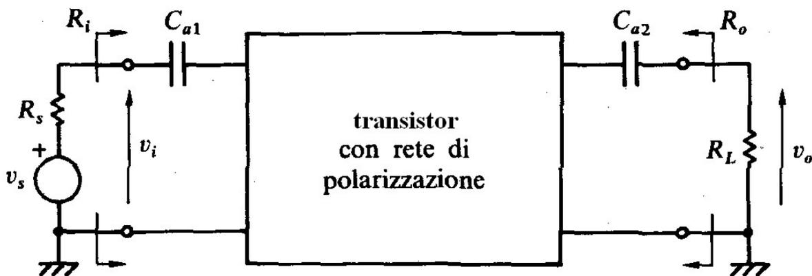
Fig. 10.15 – Schema generale di uno stadio di amplificazione
